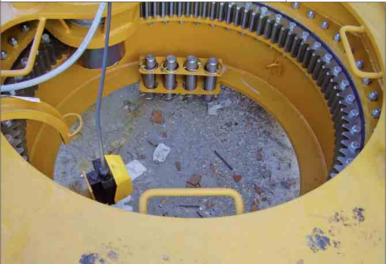
Interno dell'elemento ralla - Sistema di alloggiamento per perni di assemblaggio
