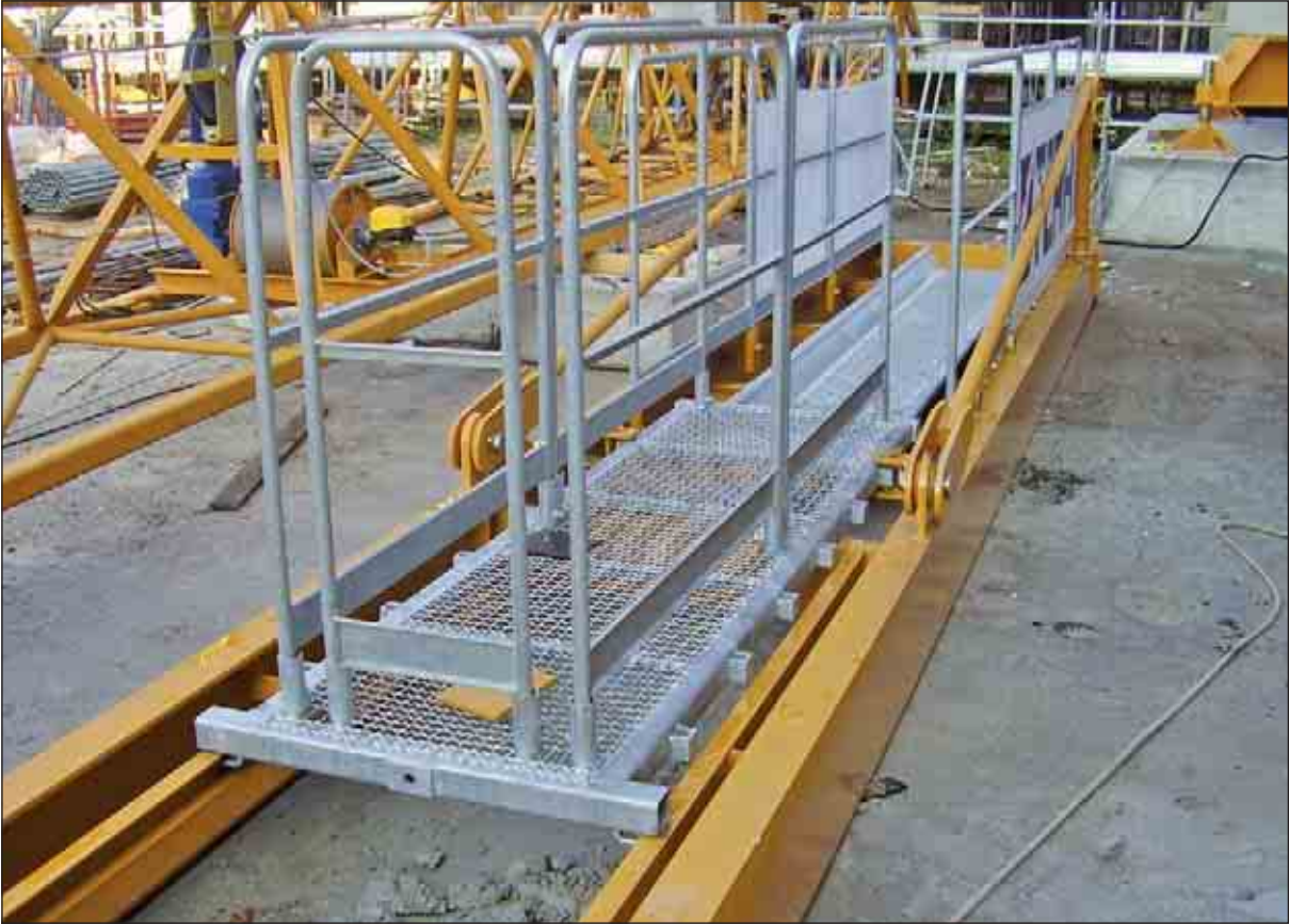
Controbraccio con passerella di servizio telescopica per adattarsi alla posa degli elementi di contrappeso
